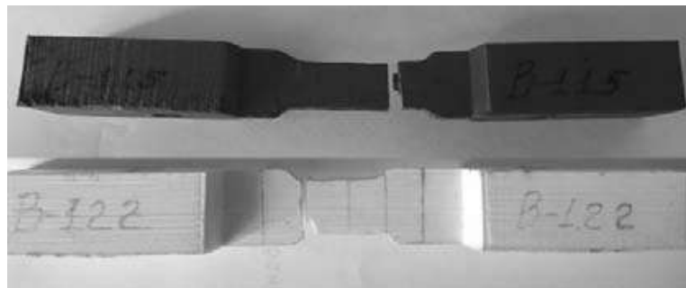
Рис. 4. Дослідні зразки пластин після випробування
