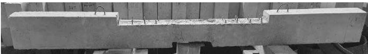
Рис. 2. Вигляд залізобетонної балки із зруйнованою стиснутою зоною бетону
