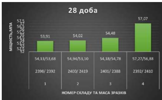
Рис. 8. Оцінка міцності затверділого бетону на 28 добу
