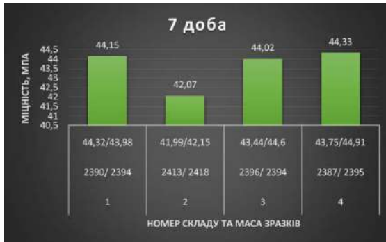
Рис. 7. Оцінка міцності затверділого бетону на 7 добу
