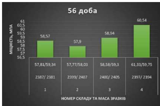
Рис. 9. Оцінка міцності затверділого бетону на 56 добу
