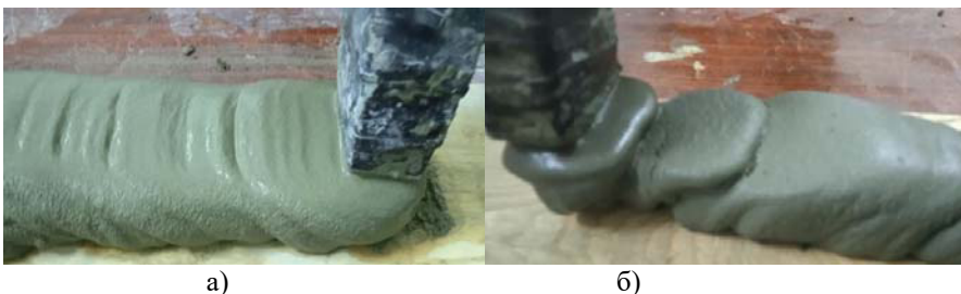
Рис. 3. Екструзія суміші з 3D принтеру, (а) – задовільна, (б) – не задовільна з розривами та напливами.
