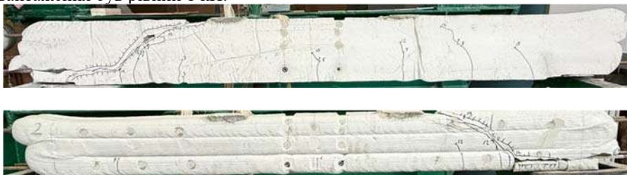
Рис. 4. Характер руйнування балки марки Б-1.1 з двох сторін
