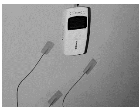
Рис. 2. Логер для реєстрації температури внутрішнього середовища та розміщення термопар для вимірювання температури поверхні стіни
