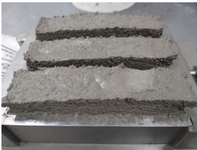
Рис. 4. Сформовані балочки з додавання ефіру целюлози 0,5 %
