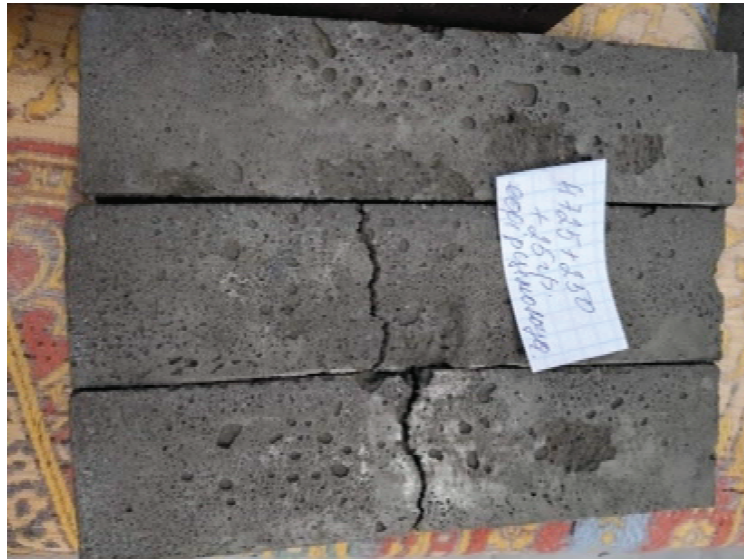
Рис. 5. Присутність пор на сформованих балочках з додавання ефіру целюлози 0,5%
