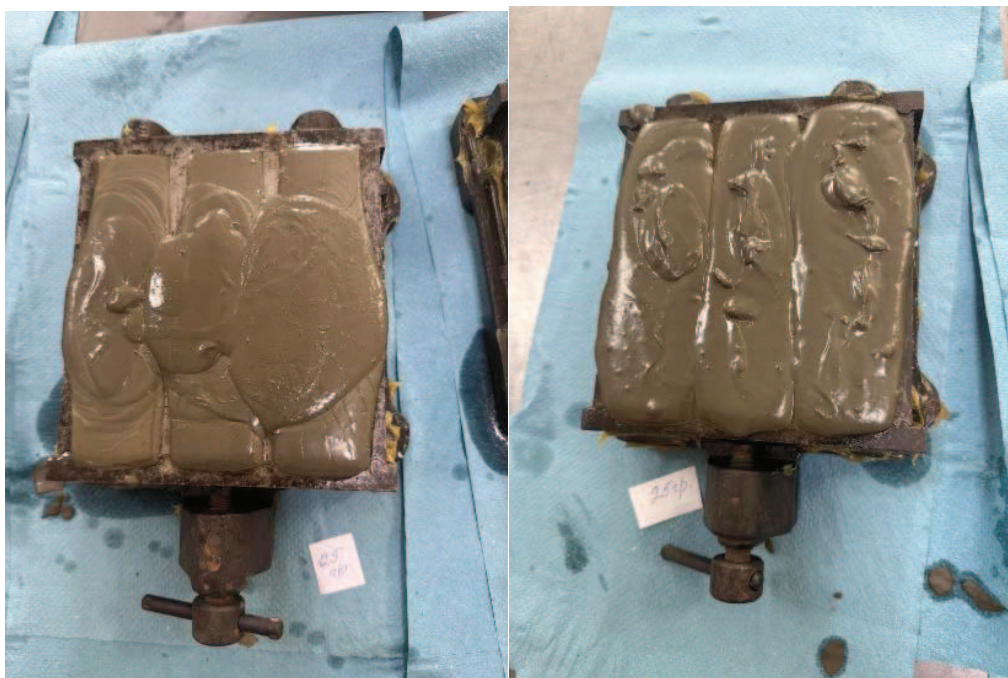
Рис. 3. Розчин після замішування при формуванні з додавання ефіру целюлози 0,25 % та 0,5 % відповідно
