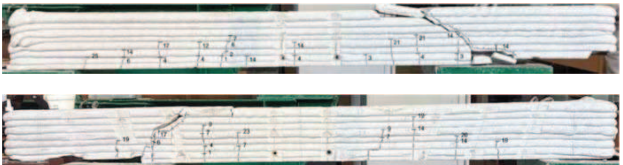
Рис. 4. Характер руйнування балки марки Б-1.1 з двох сторін
