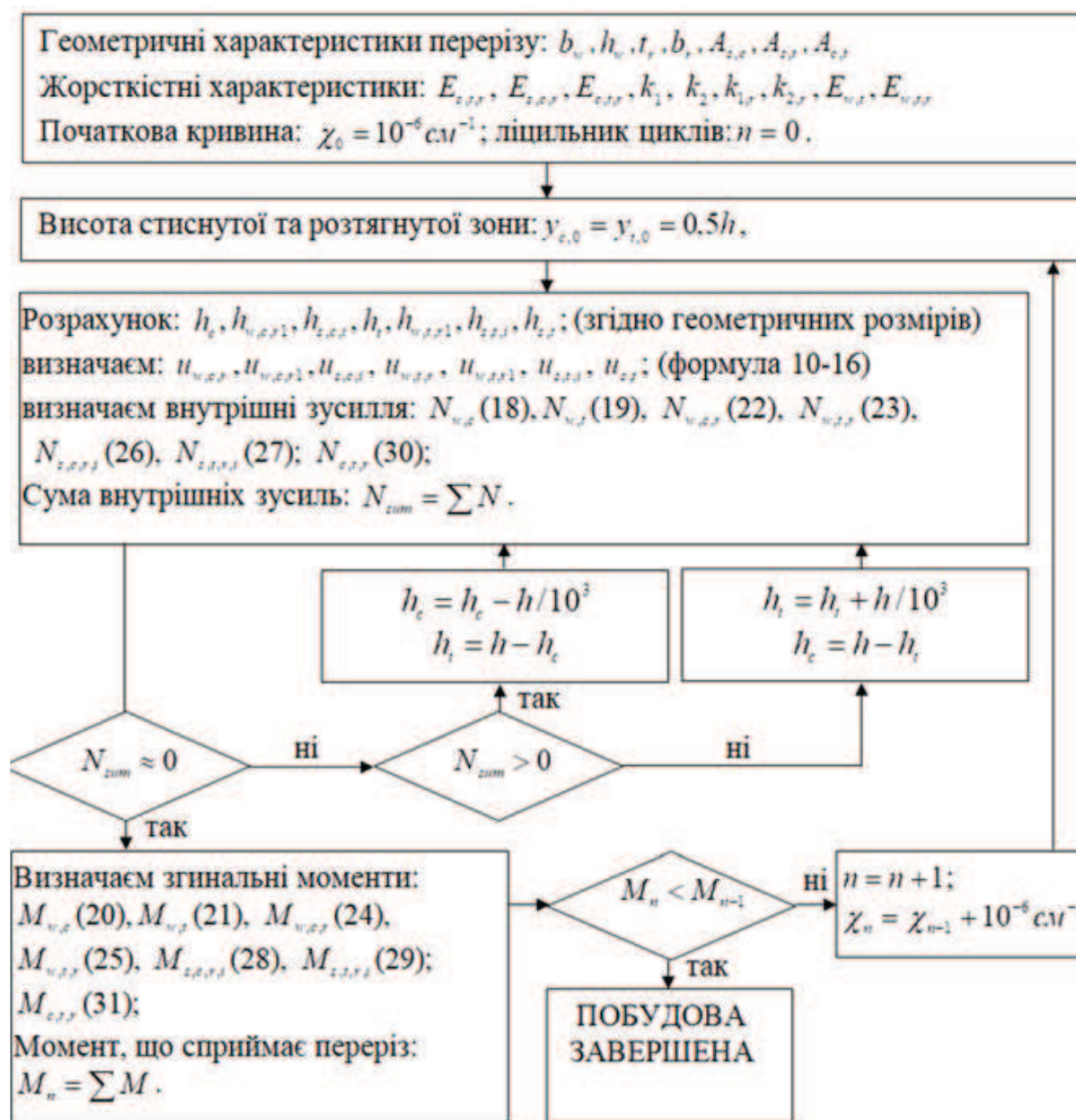
Рис. 6. Алгоритм побудови графіку момент-кривина для підсиленої дерев'яної конструкції, що працює на згин
