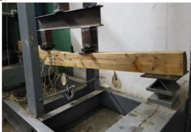
Рис.3. Руйнування замоченої у солоній воді дослідної балки з деревини ялини
