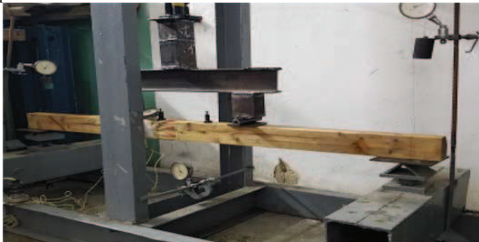
Рис.2. Випробування дослідної балки з деревини ялини
