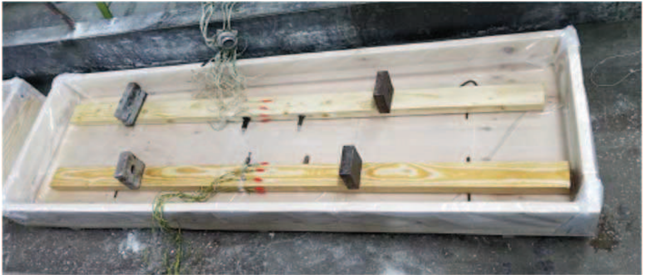
Рис.1. Занурення дослідних балок у водному середовищі
