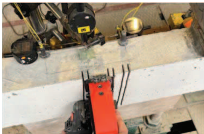
Рис. 3. Поетапне пошкодження експериментальної балки.
