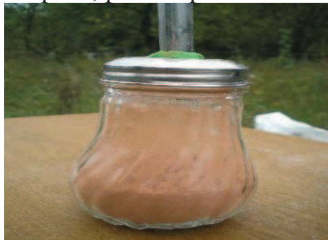
Рис. 1. Ємність для подачі суміші на гасіння полум'я магнію.
