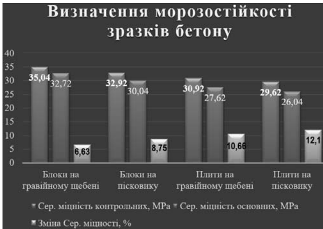
Рис. 5. Результати оцінювання морозостійкості бетонів для блоків і плит на місцевих заповнювачах (гравійний щебінь і щебінь із пісковіку)
