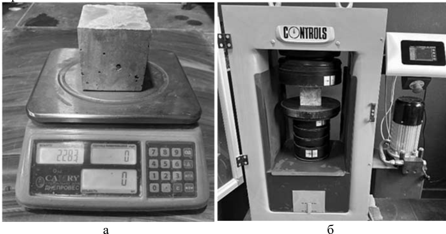
Рис. 2. Руйнівні випробування зразків бетону: а – контроль зразків; б – випробування на автоматизованому гідравлічному пресі
