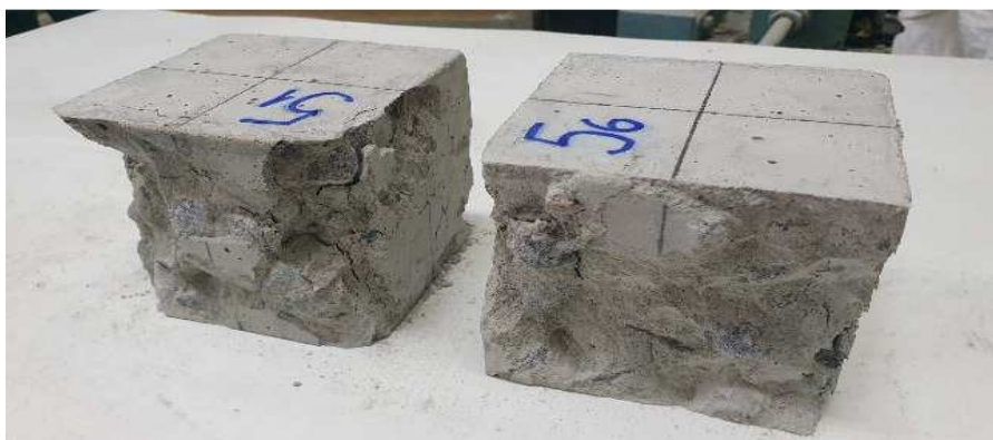
Рис. 3. Типовий характер руйнування і структура внутрішньої поверхні зразків складу 5
