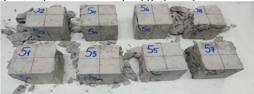
Рис. 2. Загальний вигляд бетонних зразків складу 5 після руйнування (II технологія загрузки та перемішування компонентів бетонної суміші)
