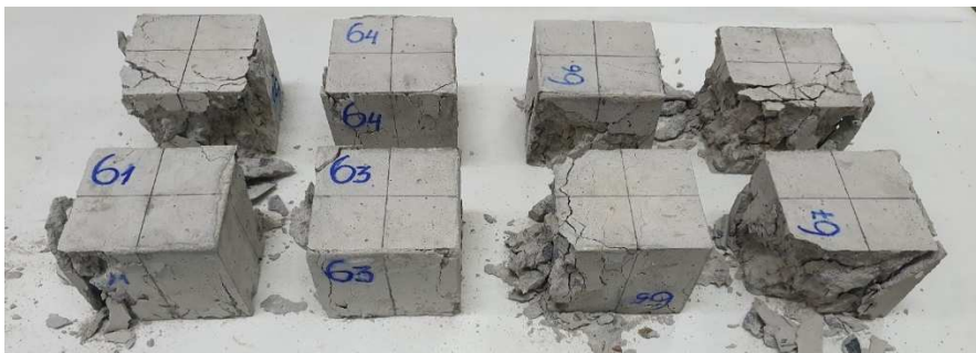
Рис. 4. Загальний вигляд бетонних зразків складу 6 після руйнування ( III технологія заправки та перемішування компонентів бетонної суміші )
