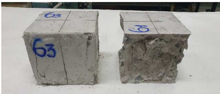
Рис. 5. Типовий характер руйнування і структура внутрішньої поверхні зразків складу 6
