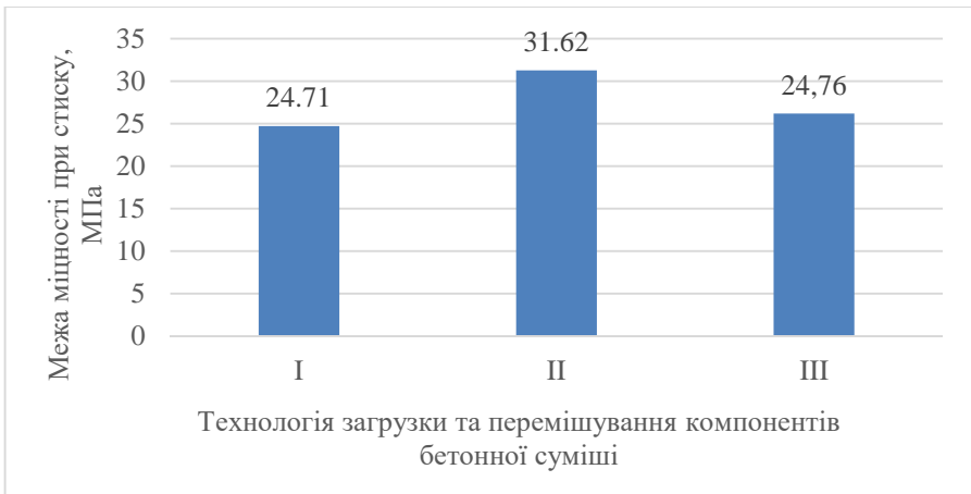
Рис. 6. Діаграми залежності середньої міцності бетонних зразків від технології заправки та перемішування компонентів бетонної суміші
