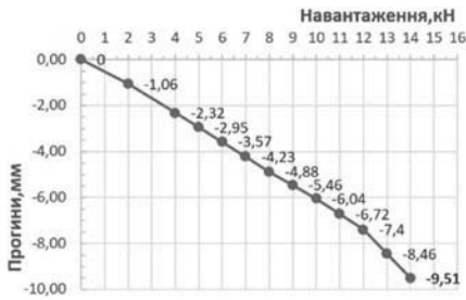
Рис. 6. Діаграма залежності прогинів від прикладеного навантаження поєдині прольоту арок. а) арка А-1.1.1, б) арка 1.1.2
