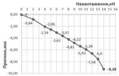
Рис. 6. Діаграма залежності прогинів від прикладеного навантаження поєдині прольоту арок. а) арка А-1.1.1, б) арка 1.1.2
