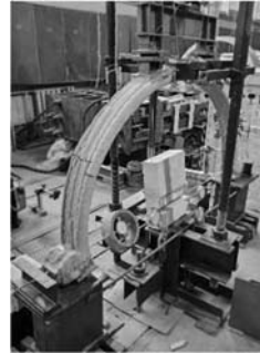
Рис. 3. Фото арки А-1.1.1. а) до експерименту, б) зруйнована арка
