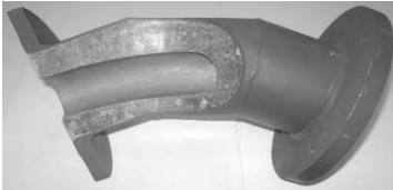
Рис. 1. Зовнішній вигляд труб і відводів малого діаметру, футерованих дрібнозернистим фібробетоном
