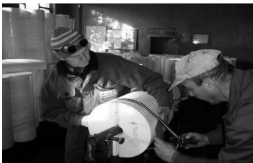
Рис. 3. Нанесення фібробетону на внутрішню поверхню труби з застосуванням вібротильового методу
