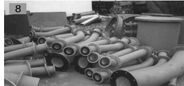
Рис. 1. Зовнішній вигляд труб і відводів малого діаметру, футерованих дрібнозернистим фібробетоном
