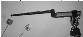
Рис. 2. Вимірювання швидкості руху повітря термоанемометром
