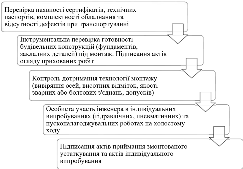
Рис. 1. Універсальна організаційно-технологічна модель (алгоритм) здійснення технічного нагляду за монтажем устаткування
